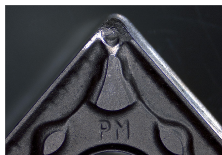
可轉位插銷，顯示工具磨損情形。 反射光，環形光源，0.8x 放大
